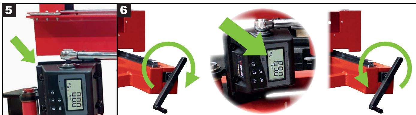
**Remarque :** Pour effectuer un test d'étalonnage correct, il est conseillé de suivre les procédures standard internationales : par exemple la norme internationale ISO 6789 ou similaire.
