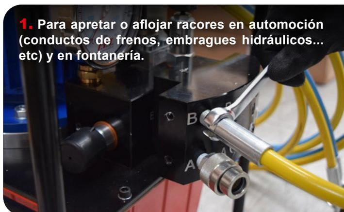
**1.** Para apretar o aflojar racores en automoción (conductos de frenos, embragues hidráulicos... etc) y en fontanería.
