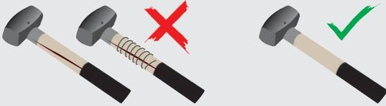
Antes de utilizar un martillo asegurarse que el mango está perfectamente unido a la cabeza. En mango cónico, cabeza bien encastrada; en resto, resina, cuña y pasador en buen estado. En aquellos que incorporen pasador de seguridad, su función es que cuando la cabeza pierda sujeción, no salga despedida. Su función no es seguir trabajando con ella. En cuanto se note la holgura en la cabeza, se debe descartar su uso.
