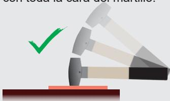
Sujetar el mango por el extremo en todo su perímetro.
