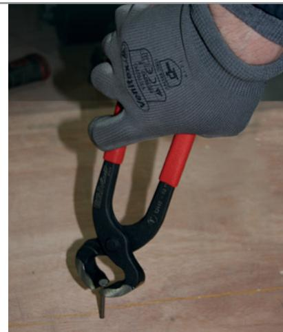
**2.** Es capaz de cortar clavos de hasta 2,5 mm de diámetro y cables de hasta 1,6 mm de diámetro de 160 kg/mm2 de resistencia a la tracción.
