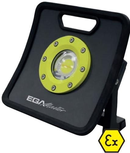
Los focos LED MasterEx 79732 y 79733 están especialmente diseñados para la iluminación de grandes espacios en zonas Ex. Las dos posiciones de intensidad del LED (50% Y 100%) permiten adaptar la intensidad de la luz emitida. Los focos son aptos para su uso en zonas 1 y 21.
