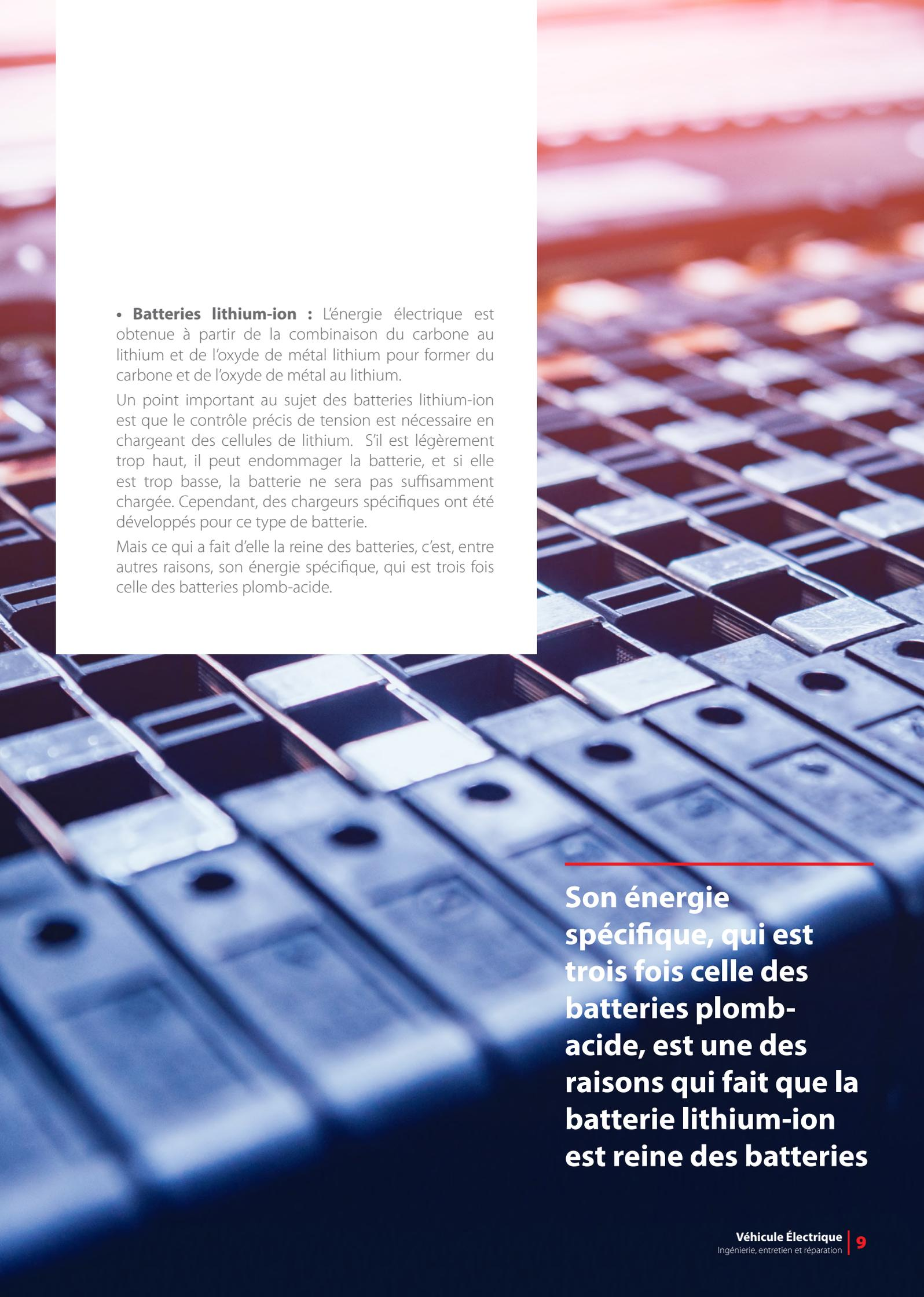
• **Batteries lithium-ion** : L'énergie électrique est obtenue à partir de la combinaison du carbone au lithium et de l'oxyde de métal lithium pour former du carbone et de l'oxyde de métal au lithium.
